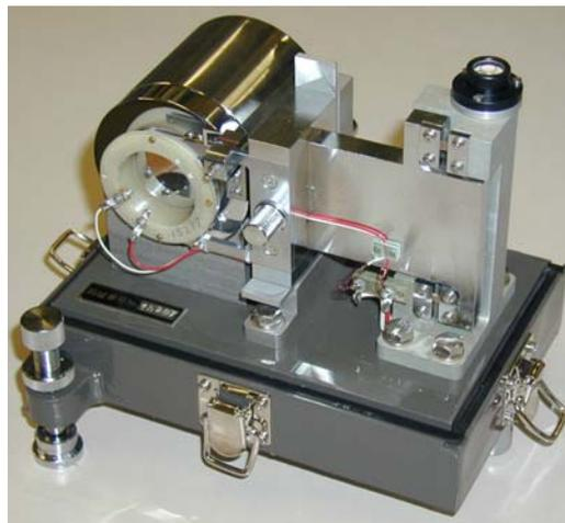
写真 1 動コイル型地震計の例
